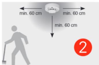
Entfernen Sie sich innerhalb von **10 Sekunden min. 60 cm** aus dem Umkreis des Rauchwärmelders.
