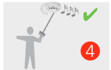
Drücken Sie für ca. **5 Sekunden** die Benutzer-Taste. Wenn der **Testalarm** ertönt, (1 Sek. an / 1 Sek. aus) ist der **Rauchwarmmelder funktionsfähig**. Falls nicht, rufen Sie schnellstmöglich die kostenfreie **Hotline** an: **08002 001264**.
